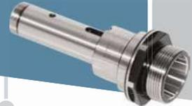
**Albero porta-utensile in acciaio legato, temperato e con doppio labirinto. Completamente rettificato, con tolleranze inferiori ai 5 micron, per garantire una durata maggiore dell'utensile in lavorazione.**
