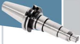
**Albero con cono in acciaio cementato e temperato. Realizzato in un solo pezzo per aumentare il carico alla flessione del 25%, interamente rettificato ed equilibrato a 6,3G. Riesce a raggiungere alte velocità senza vibrazioni.**
