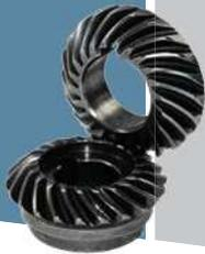
Ingranaggi realizzati in superleghe di acciaio, temperati e interamente rettificati. Vengono trattati con lucidatura isotropica che conferisce loro una rugosità pari a 0,01 Ra e un abbattimento notevole delle vibrazioni e dell'attrito.
