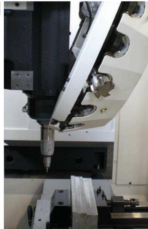
TESTE CON MOTORE AD ARIA
